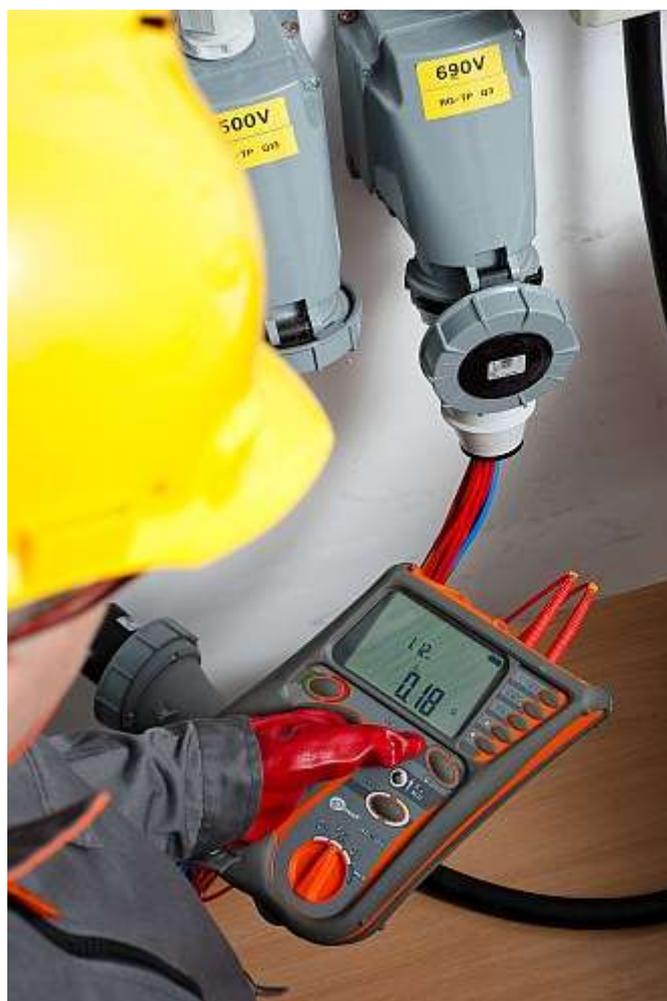
Несмотря на слегка увеличенный размер корпуса, прибор уверенно удерживается и управляется одной рукой. Измеренные значения сопротивления петли короткого замыкания могут быть сохранены во встроенную память измерителя и переданы по USB на компьютер для дальнейшей
