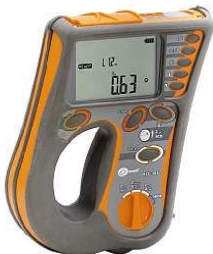
Функции измерителя представлены исключительно режимами измерения параметров петли короткого замыкания для цепей «фаза-нуль», «фаза-фаза», «фаза-защитный проводник». Характеристики при проведении измерений петли фактически эквиваленты возможностям MZC-304.
